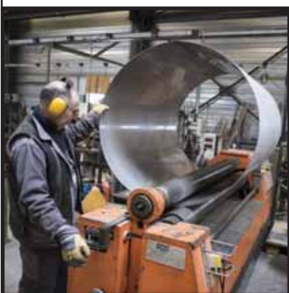
La technicité du chaudronnier permet de réaliser des objets modelés comme ce fond bombé (à droite).
