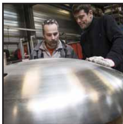
La technicité du chaudronnier permet de réaliser des objets modelés comme ce fond bombé (à droite).
